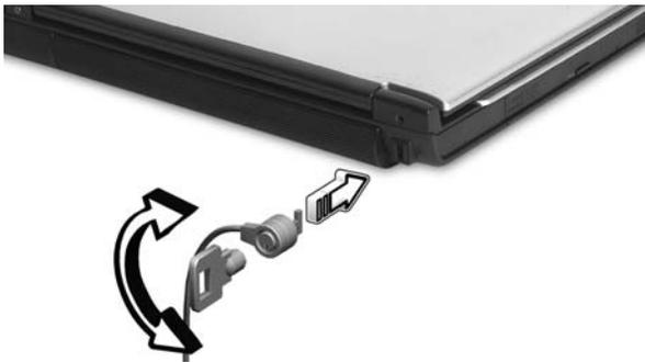
將電腦安全鎖電纜線繞著無法移動的物品打個圈，例如，桌子或鎖住的抽屜把手。再將鎖插入鎖孔中，並轉動鑰匙以便上鎖。也有一些沒有鑰匙鎖孔的機型，以供使用者選擇。
