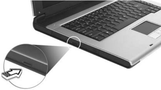
若在電腦電源關閉時，您可使用緊急退出孔來退出光學裝置托盤。
