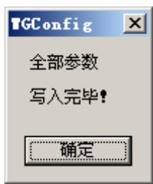
进行写入操作时，需要注意“读写目标”的选择。写入**ROM**掉电后数据不会丢失，写入**RAM**掉电后数据会丢失，但某些参数可立即生效（不用重启设备即刻生效）。建议同时选中 ROM 和 RAM 进行写操作。
