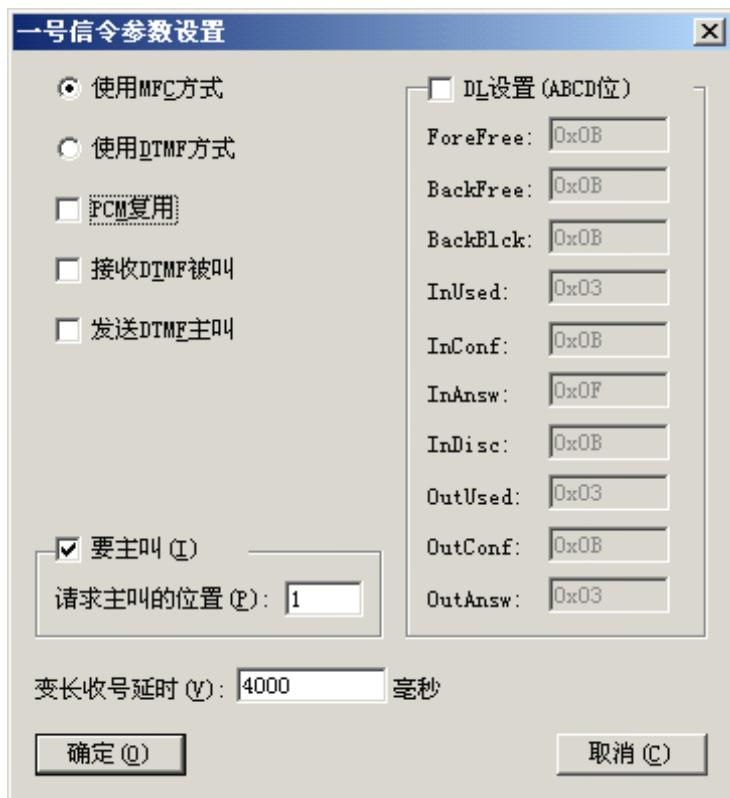
设备支持 MFC 和 DTMF 两种发码方式。PCM 复用, 用于数模转换, 将时隙通道与模块线路一一对应, 相当于模拟线路通过 E1 延伸。通常缺省的设置就可以对接成功, 如果对端要求比较特殊, 按以手工指定 DL 值。
