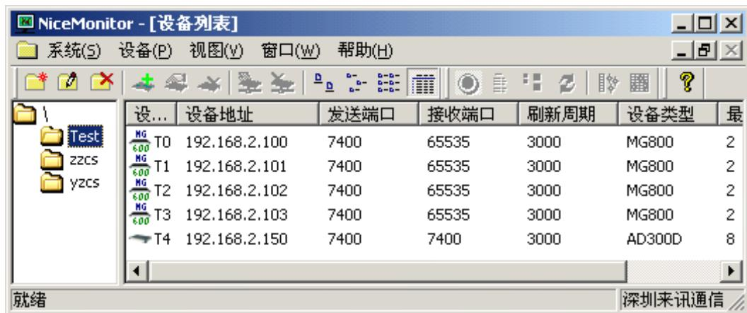
NiceMonitor 是来讯公司的通用 PCM 监控软件，可以监控来讯生产的所有提供 PCM 接口的设备。当同时监控多台设备时，每台设备的发送端口不能相同，必须设置为不同的值。
