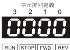
Bit 0=1 時，在距離控制模式下，變頻器偵測到開關門限位信號異常；或多段數模式三，開關動作沒有依照段速順序作動，此時 LC-M2E 會顯示 PSEr (位置信號錯誤) 警告，變頻器改以低速運轉頻率 (1-07) 運轉，如將多功能輸出端子功能設定 07，則此時會輸出警告信號。
