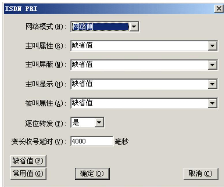
**网络模式:** 两种选择, 网络侧或用户侧。对接两端不能相同。
