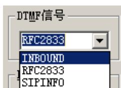
有三种模式指定如何传送 DTMF 信号。RFC2833 使用 RFC 标准传送。INBOUND 表示带内，使用语音信号透传。SIPINFO 使用 SIP 信令传送。通常使用 RFC2833。
