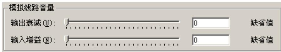
滑块移向右边音量增大，移向左边音量减小。输出衰减对应调整对方听到的音量，输入增益对应调整本端听到的音量。
