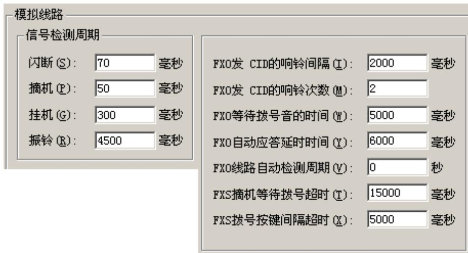
上图参数所设表示，挂机 300 毫秒后设备认为用户挂机，摘机 50 毫秒后设备判断为摘机。挂机时间在 70 毫秒到 300 毫秒之间，判断为闪断。振铃的周期为 4500 毫秒。
