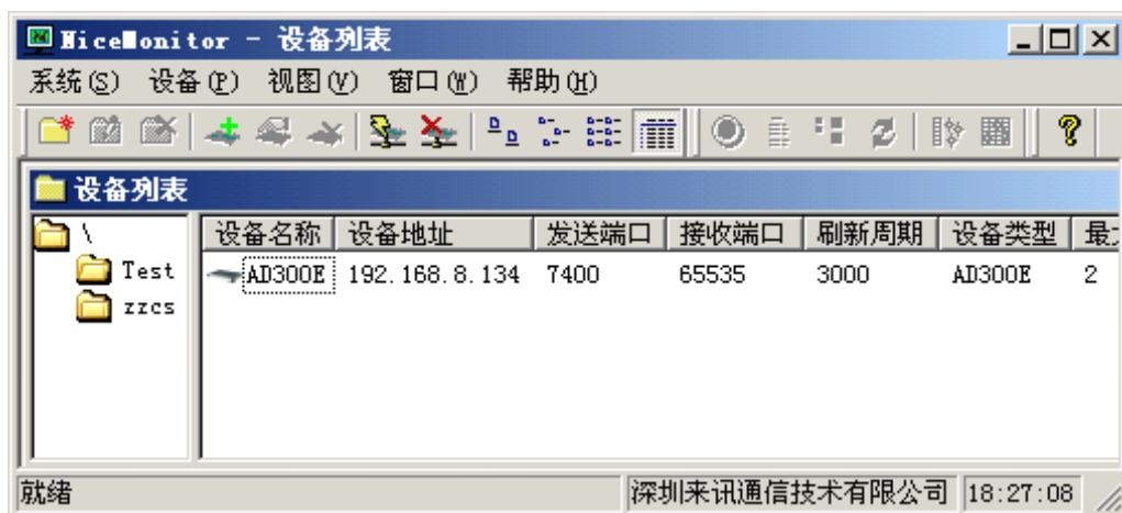
NiceMonitor 是来讯公司的通用 E1 监控软件，可以监控来讯生产的所有提供 E1 接口的设备。当同时监控多台设备时，每台设备的发送端口不能相同，必须设置为不同的值。
