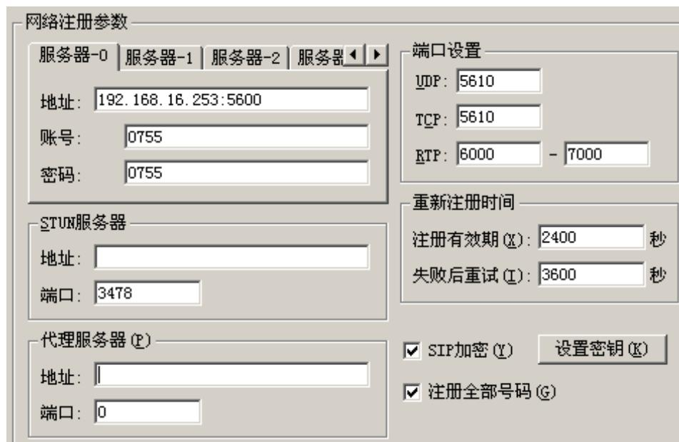
AD300E 支持同时注册五个服务器，地址可以是 IP 地址，也可以是域名。如果不是默认的 5060 端口，则在地址后面加冒号加指定的端口号，如“wsncc.net:55000”表示使用端口 55000 去注册 wsncc.net。重新注册时间可以设置每隔一段时间就重新发起注册请求。
