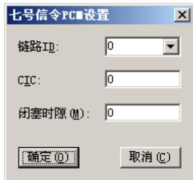
**链路 ID,** 此 PCM 所选用的七号信令链路的编号, 参见后面的七号链路说明。在使用七号信令前, 必须先添加链路。
