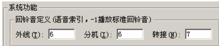
AD300E 可以指定三种呼叫情况下的回铃音。外线表示从外部呼入时的情况，分机表示分机互拨时的情况，转接表示分机代答时的情况。
