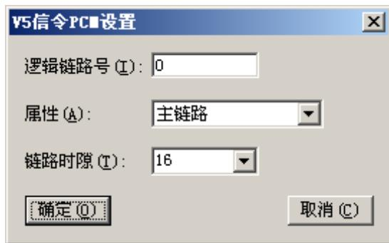
**逻辑链路号**，标识 V5 链路内 PCM 顺序的一个逻辑编号，对接两边必须一致。
