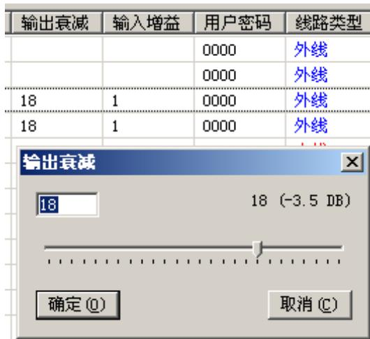
在“输出衰减”或“输入增益”列上点击，弹出设置对话框，滑块移向右边音量增大，移向左边音量减小。
