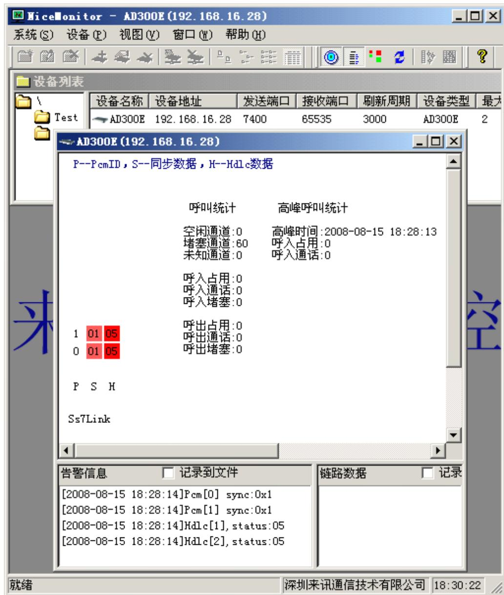
每个 E1 由两个方格表示，红色表示故障，绿色表示正常。左边的方格代表物理同步信号。右边的方格表示 HDLC 链路状态。“Ss7Link”下面是七号信令链路的状态。在同步方格上双击，可以打开当前 E1 的通道状态表。在链路上双击，可以打开链路数据跟踪。
