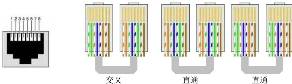
模拟用户线，由用户自己制作，如下图所示，压制水晶头。
