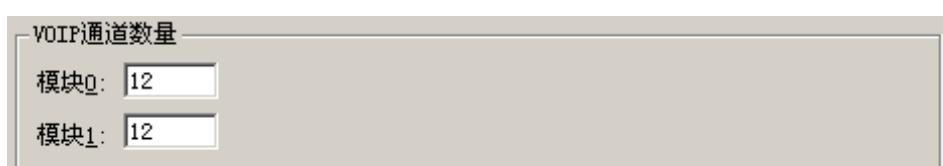
一个压缩模块最多 12 个通道，AD300E 最大可以插两个压缩模块。
