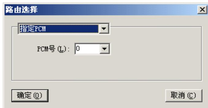
PCM号, 即PCM的编号, 从指定的PCM内顺序选择时隙通道呼出。
