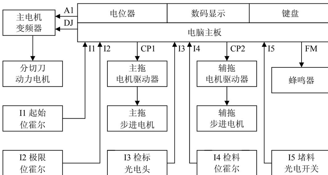
SJ-C01A 型制袋机微机控制系统由微电脑、数码显示、键盘、电源和两个步进电机驱动器及相应的传感开关组成。
