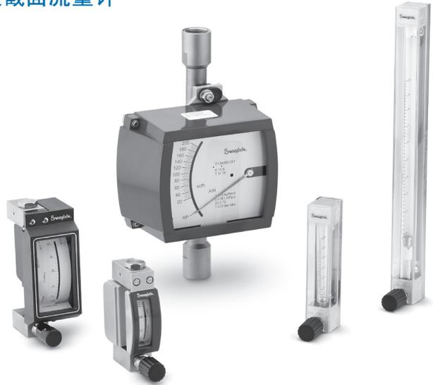
世伟洛克® (Swagelok®) 变截面流量计使用锥形管和浮子测量液体和气体的流量。流量增高时会推高浮子，流量减小时，浮子将在重力作用下下降。变截面流量计不需要外部电源，不过，也可以订购带电子或电气选购件的产品。
