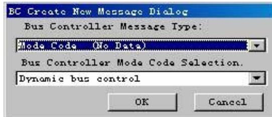
消息类型和模式代码的具体含义请参考 MIL-STD-1553 标准。当用户选择好后，执行 OK 就可以了，用户会发现刚才的窗口中的命令字区会有明显的变动。这时，用户就可以再手动地对该消息进行编辑了。也就是说先确定消息的类型，再对该类型的消息进行具体项的配置。
