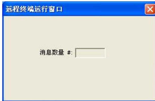
Run 命令会将已经编辑好的子地址数据发送出去，而 Message#则和 BC 中的运行窗口功能相同，仅显示现收到的消息数量。
