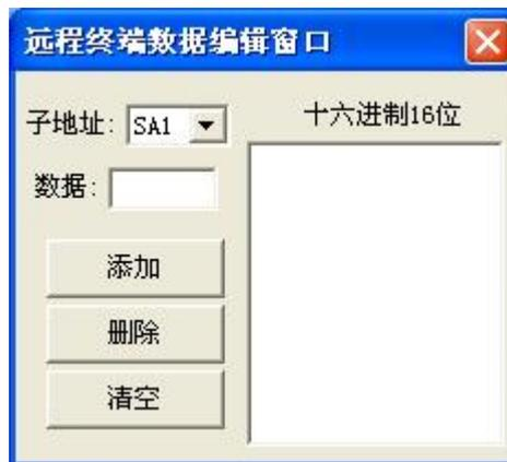
该窗口用于子地址数据编辑，子地址共有 30 个从 1 到 30，每个子地址都最多可以有 32 个数据，每个数据为 16 位，该窗口中无论是显示还是填写 Data (数据) 均采用十六进制的形式。子地址可以通过子地址列表窗口进行选择。用户应先选择好一个子地址，然后将要编辑的数据填写在 Data (数据) 文本窗口中 (注：一定要采用 16 进制，长度为 16 位)，填写完成后，可以执行 Add (添加) 命令将数据添加到右边的数据列表窗口中。Delete (删除) 命令只会将列表末尾的数据进行删除，当列表为空是，它什么也不会做。Clear (清空) 命令会将列表中的所有数据清除掉。完成数据编辑后，点击一下窗口右上角的关闭按钮就可以了。
