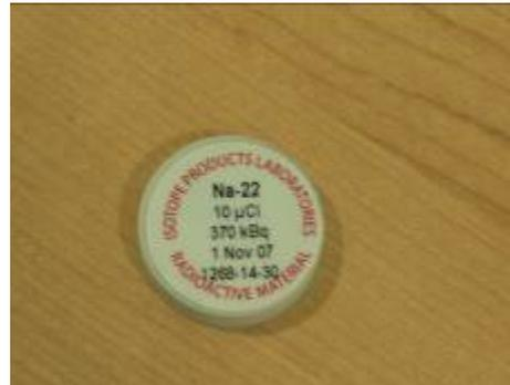
圖五：原廠校正用射源
