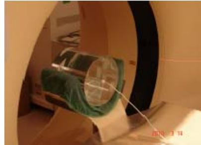
4.5 使用常規成人頭部檢查的掃描參數，若常規檢查是使用螺旋掃描，則測量劑量時應改為軸狀掃描，但其他參數應維持相同，檢查床不移動。在軸狀掃描下，若無法選擇相對應於螺旋掃描之偵檢器組置，可選擇射束寬度最接近者，或在工程師的協助下進入維修保養模式完成此部份之測量。
