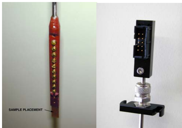
图 12、手动插入样品杆底部和顶部示意图
