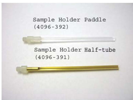
图 27、SQUID-VSM 样品固定杆（针对不同类型样品）
