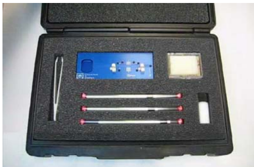
图 28、高温炉样品安装组件
