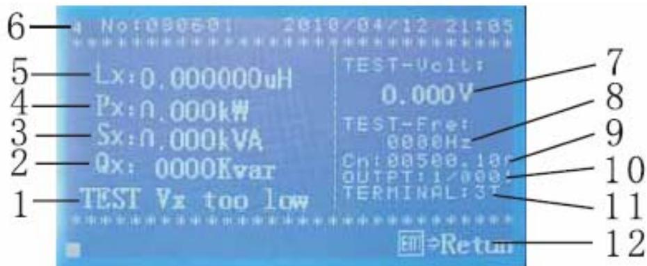
(1)- 标准臂的电流 ( $I_{cn}$ )  $\leq 0.1\text{mA}$  时, 显示 ‘试验电压低!’ 的提示, 当电流  $> 0.1\text{mA}$ , 提示会自动消失, 并显示所测电抗器的额定电流。所有的功率计算, 都是根据所设定的额定电流来进行计算的。
