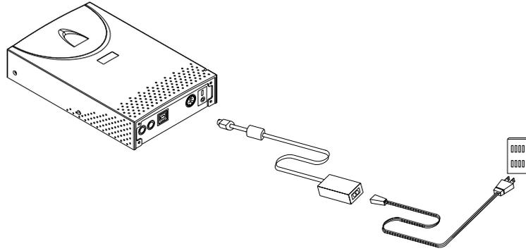
2. 将 USB 2.0 专用线的一端接到刻录机背面的 USB 接头。
