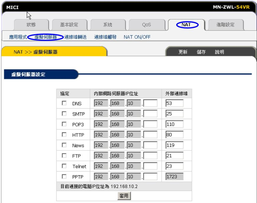
本路由器自身集成了防火牆，這樣網際網路中的電腦要想通過本路由器訪問區域網路中的某些伺服器，則在預設設定下無法通過防火牆的防護，這就出現了一對矛盾，路由器既要保護網路不被侵襲，又要方便網際網路合法的用戶訪問。這裏，本路由器提供了**虛擬伺服器**功能，即可以解決這一對矛盾。虛擬伺服器定義一個服務埠，所有對此埠的服務請求將被重新定位給通過IP位址指定的區域網路中的伺服器。
