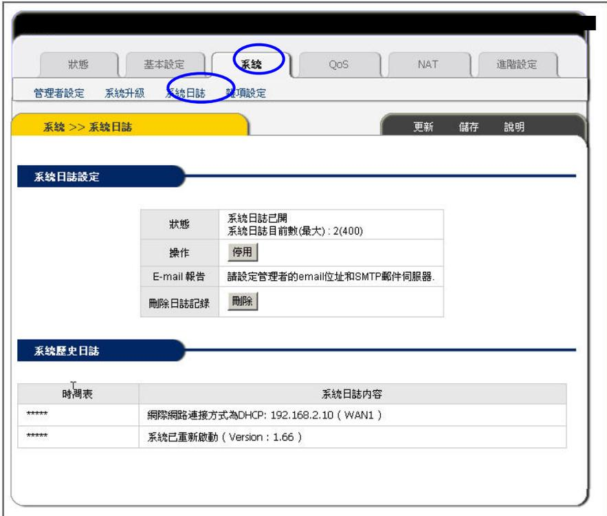
該頁面記錄了路由器的系統日誌，並可通過操作按鈕切換系統日誌的狀態，您可以通過查詢日誌瞭解路由器上所發生的系統事件。
