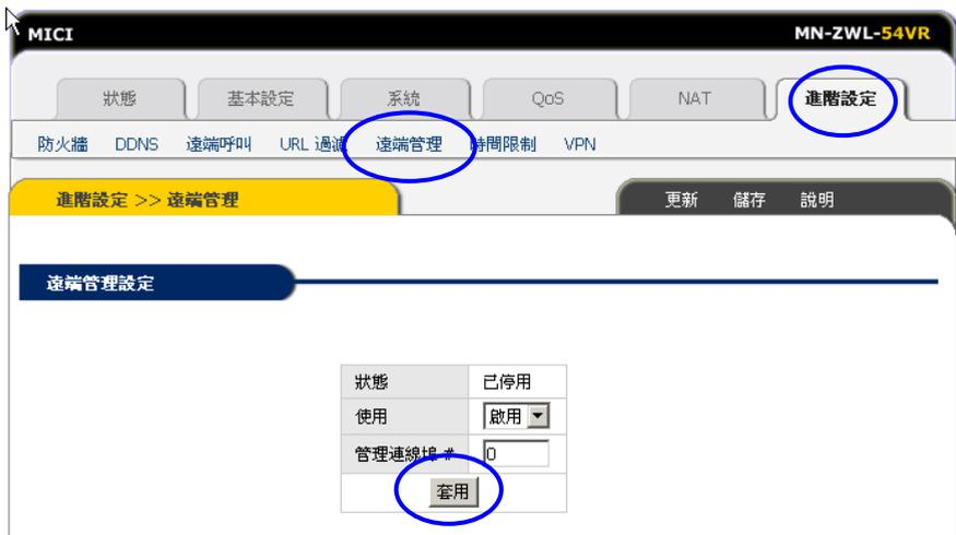
本頁設定路由器的遠端管理開關及WEB管理埠。開啓遠端管理之後，用戶可通過“http://WAN口IP地址:用戶設定的埠號（中間爲冒號）”遠端管理此路由器；如要開啓遠端管理，設定**管理埠號**然後點擊**套用**。
