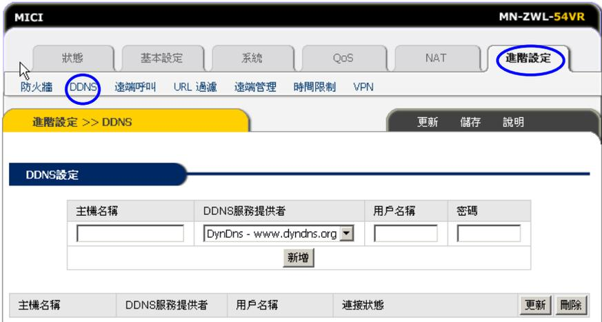
通常使用ADSL或Cable Modem等方式連接Internet時，ISP會分配一個動態的IP位址，動態功能變數名稱解析就是把功能變數名稱與用戶每次上網從ISP獲得的動態IP位址對應起來。但動態功能變數名稱解析服務依賴於動態功能變數名稱解析系統。此功能能夠讓用戶使用註冊的動態功能變數名稱服務，而不管IP位址如何改變。
