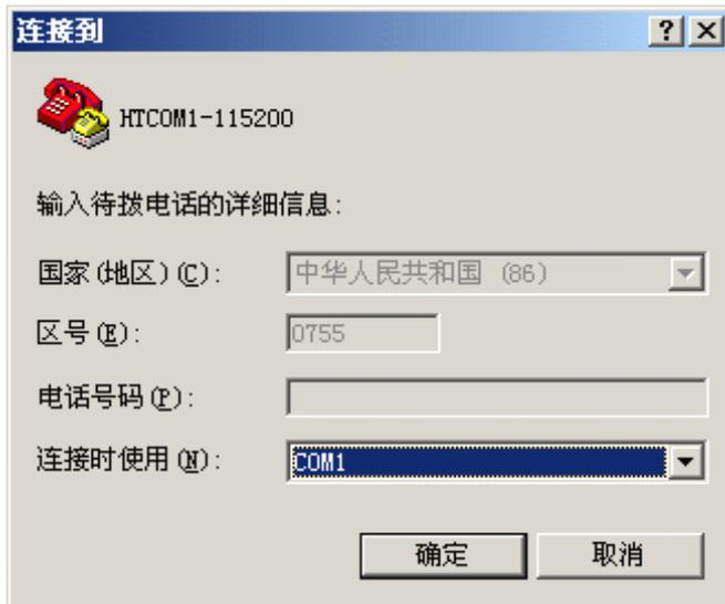
根据设备主控板上串口所连接的计算机串口来设置。选好后点击“确定”，弹出接口的属性设置对话框。
