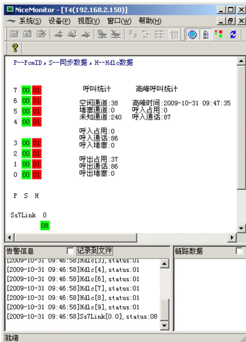
每个 E1 由两个方格表示，红色表示故障，绿色表示正常。左边的方格代表物理同步信号。右边的方格表示 HDLC 链路状态。“Ss7Link”下面是七号信令链路的状态。在同步方格上双击，可以打开当前 E1 的通道状态表。在链路上双击，可以打开链路数据跟踪。
