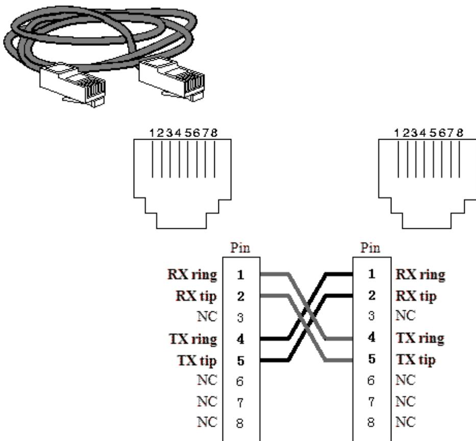
E1 线，通常会配置 RJ45 转 BNC 的线，如果对端也是 RJ45，可按下图自行制做。
