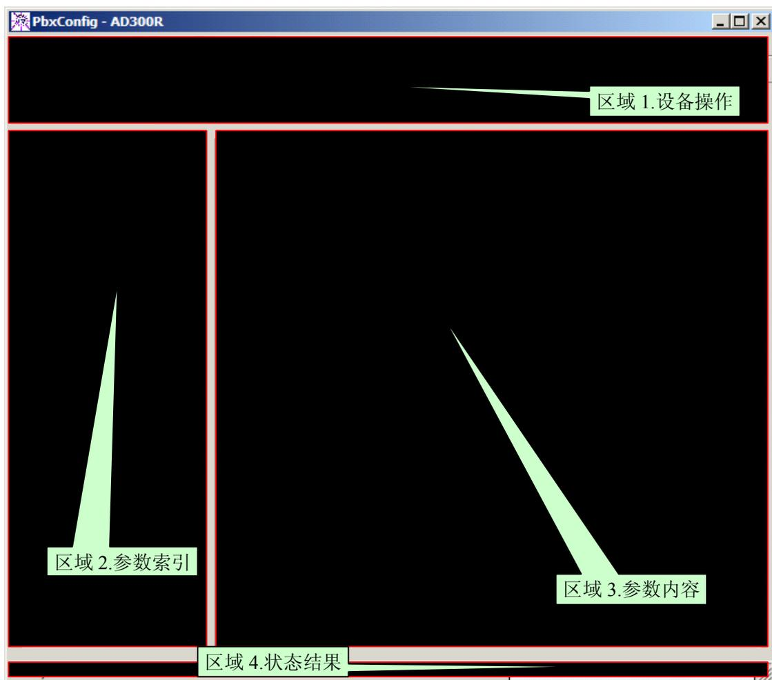
界面大致分为四个区域，设备操作、参数索引、参数内容和状态结果。**设备操作区**，包含菜单和工具栏。**参数索引区**，是设备工作参数的一个归类索引。**参数内容区**，显示当前参数索引内的具体参数。**状态结果区**，显示相关的操作状态和结果。
