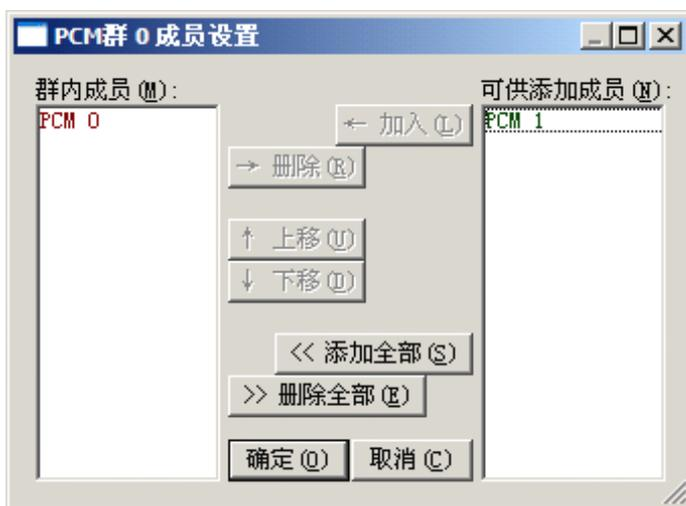
操作说明：群号已经是固定好的，只需要在后面设置群内的成员。在成员列单击，弹出成员设置对话框。左边是已经在群内的成员，右边是不在群内的成员。先选中成员，然后点击“加入”按钮进行添加，“删除”按钮进行删除，“上移”和“下移”可以调整顺序。
