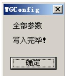
进行写入操作时，需要注意“读写目标”的选择。写入 **ROM** 掉电后数据不会丢失，写入 **RAM** 掉电后数据会丢失，但某些参数可立即生效（不用重启设备即刻生效）。建议同时选中 ROM 和 RAM 进行写操作。
