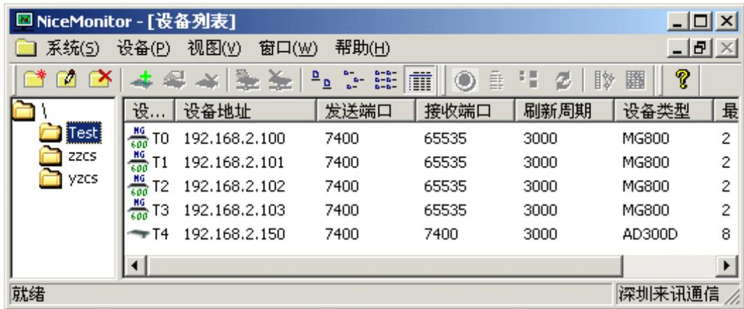
NiceMonitor 是来讯公司的通用 PCM 监控软件，可以监控来讯生产的所有提供 PCM 接口的设备。当同时监控多台设备时，每台设备的发送端口不能相同，必须设置为不同的值。
