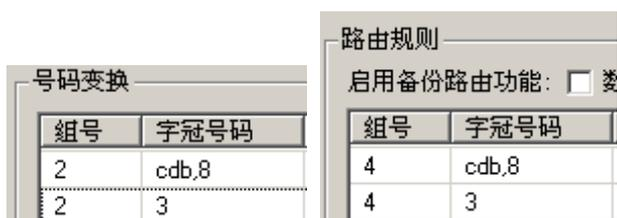
如上图所示，首先添加一条字冠号码为“cdb,xx”格式的虚拟规则，xx 表示字冠长度，如上图中表示要匹配 8 位长度的字冠号码。然后再添加实际的规则。
