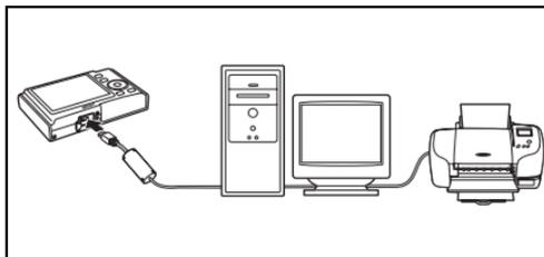
使用附带的 PictureProject 软件将照片复制到计算机，然后再整理、浏览、编辑并保存这些照片。您还可以通过与计算机连接的打印机打印照片。使用附带的 USB 线将相机连接至计算机。
