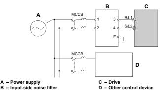
Figure 7.6 Input-Side Noise Filter (Single-Phase 200 V)
