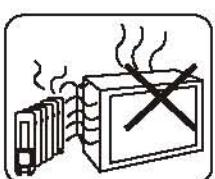
机内温度过高易引起电视机损坏，应保证电视机通风良好，切勿堵挡电视机散热孔。电视机应远离热源(如：暖气、火炉等)处，并避免阳光直射。
