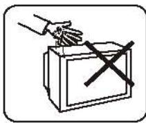
切勿将异物(如：铁屑、项鍊、硬币等)插入机内，以防引起电路短路着火，损坏电视机。
