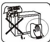
勿用酒精、氮水、稀释剂等清洗电视机表面，若确有必要，请用湿海绵或软布(可加少量中性洗涤剂)拧干后清洗，并切记在清洗前切断电源。
