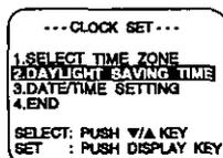
**3** Press **DISPLAY** to display the **DAYLIGHT SAVING TIME** menu.
