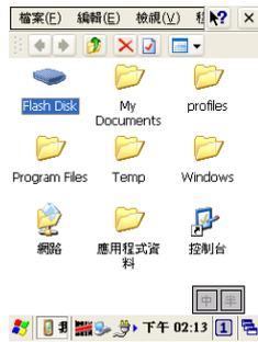
Flash Disk是一个可读写的存储器，总容量为128MB (但会因OS不同的关系，容量也会有所不同)。储存在里面的资料档案不会受到PT-60 电源状态的影响，在PT-60没电的状态下资料不会丢失。
