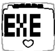
5. 在时间显示模式下，按下前侧按钮进入菜单，萤幕显示“EXE(锻炼模式)”。如果在锻炼时，你需要开启心率表的夜光照明功能，请在时间显示模式下按住前侧按钮，从而开启夜间模式(FS2/FS3)。
