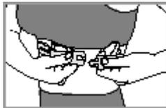
2. 调节弹性带的长度，使其贴身舒适。把弹性带围于胸部（恰好在胸肌下方），并将弹性带扣在心率传输带的另一端上。
