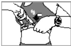
3. 将心率传输带从胸部拉开，**然后湿润其背部的槽形电极部分**。检查湿润的电极部分是否紧贴你的皮肤，同时 Polar 标志应处于正中直立的位置。
