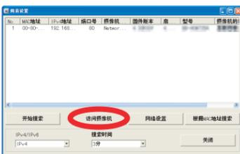
若要手动指定所有网络设置, 或用路由器的 DHCP 功能指定 IP 地址, 请单击 [网络设置], 然后选择 [指定 IP 地址] 或 [DHCP 设置] 并输入正确的设置。
