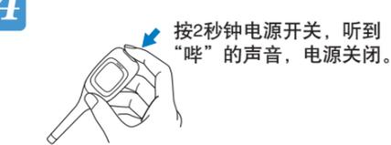
提示 若不关闭电源，将会继续开始实测。若持续闲置，约3分钟后自动电源关闭功能将自动关闭电源。
