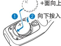
4 将电池盖按原样装好，并用螺丝固定。
