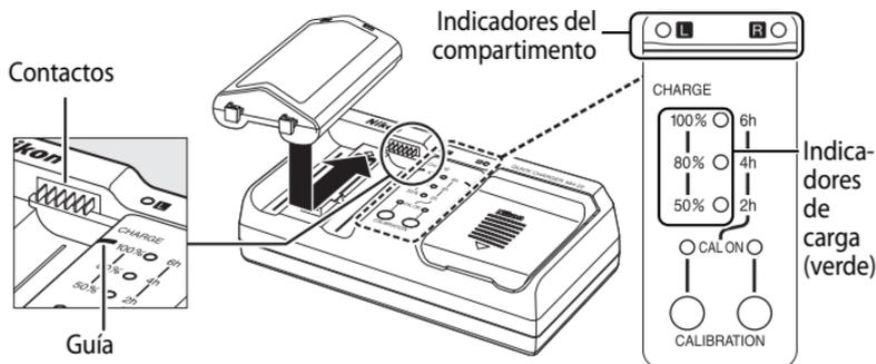
Introduzca la batería (primero los terminales) alineando el extremo con la guía y, a continuación, deslizándola en la dirección indicada hasta que haga clic en su posición. El indicador del compartimento y los indicadores de carga parpadean mientras se carga la batería:
