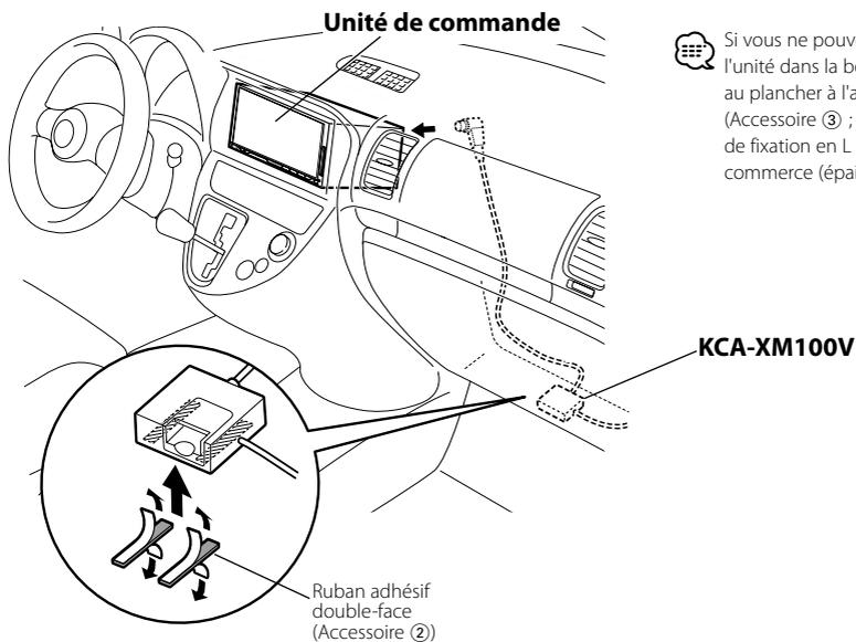
Si vous ne pouvez pas installer l'unité dans la boîte à gants, fixez-la au plancher à l'aide des vis fournies (Accessoire ③ ;  $\varnothing 4 \times 8 \text{mm}$ ) et de pattes de fixation en L disponibles dans le commerce (épaisseur : 1,6mm).
