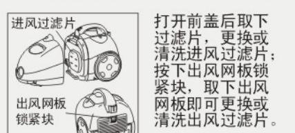
打开前盖后取下过滤片，更换或清洗进风过滤片；按下出风网板锁紧块，取下出风网板即可更换或清洗出风过滤片。
