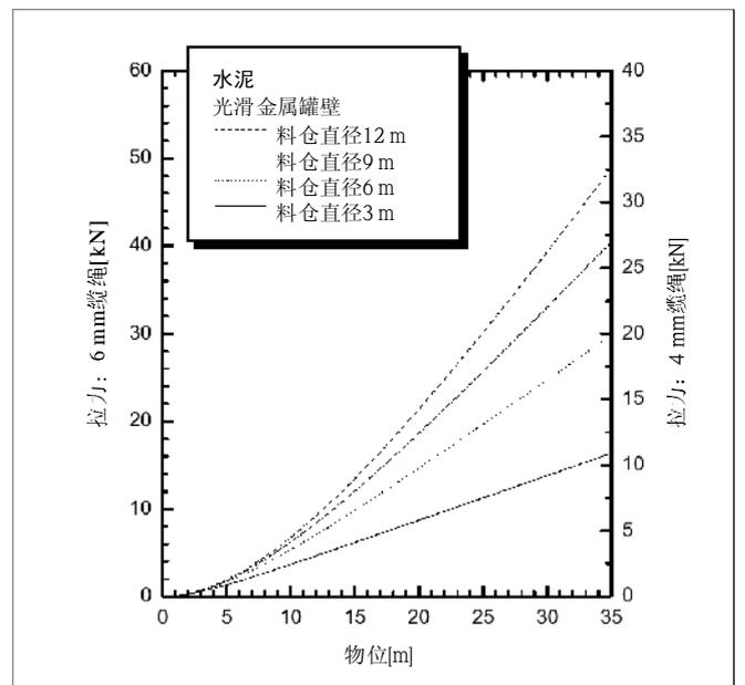
因为拉力取决于介质粘度，对于高粘度的介质或者有黏附的场合需要高的安全参数。在临界状态下采用6mm缆绳替代4mm缆绳。
