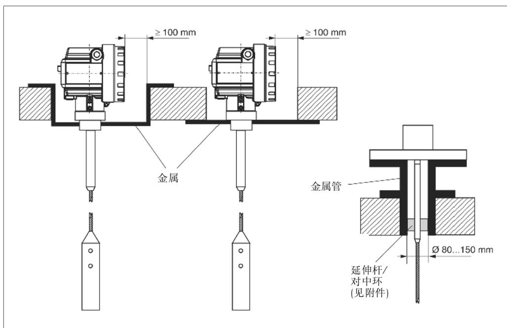
安装短管直径 $>150mm$ 时应使用对中环，防止在短管内部产生黏附。
