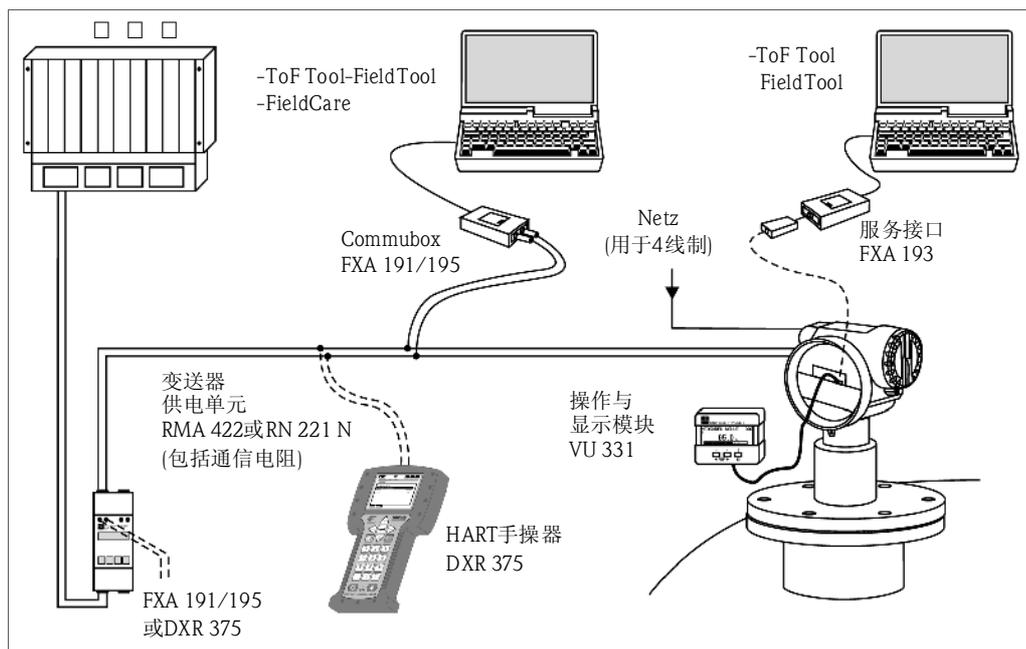
如果回路内没有安装HART通信电阻，使用HART手操器时必须要在回路内串联一个大于250Ω的通信电阻。
