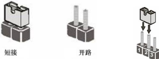
以上是 3 个针脚跳线的举例，第一个针脚和第二个针脚是短接状态。
