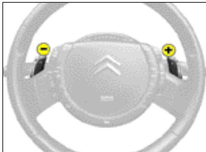
方向盘上的控制开关
