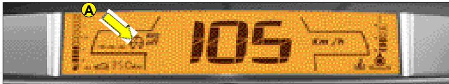
加速到期望的速度，然后按下按钮2或4。此巡航速度将被存储，并显示在仪表板的A区。
