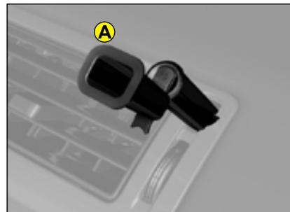
若要卸下滤芯，请取下要安装的新滤芯的盖帽A将其盖在已卸下的滤芯上。拉出。
