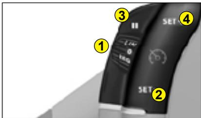
此驾驶辅助装置允许您选择不希望超过的最大速度。此速度必须大于30km/h（大约20mph）。
