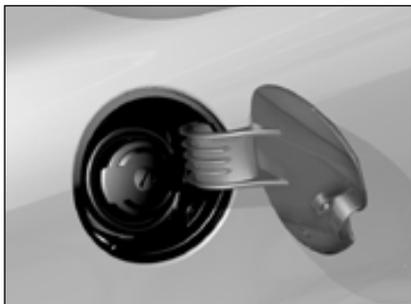
拉开带槽口的边缘，即打开燃油阀瓣。阀瓣内贴有显示正确燃油质量的标签（见“油品”）。
