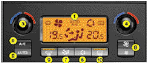
此系统会根据所选温度自动调节乘客舱的温度、空气流向和流量。（针对右侧或左侧）如果永久使用自动模式（按自动按钮）并且使所有通风口都处于打开状态，则系统无论在任何气候条件下，都能提供最佳舒适度。如果空气流量为零，则会妨碍全部空调和系统的运行。
