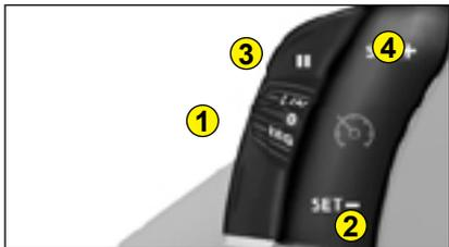
此驾驶辅助功能允许您以自己选择的速度行驶，而无需油门操作。此功能仅在高档状态且车速超过40 km/h(25mph)以上时才可用。巡航控制按钮A位于灯光 / 信号控制手柄下。
