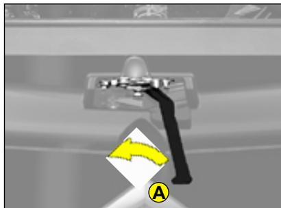
将格栅上面的操纵杆A移到V形符号的右侧，然后抬起。
