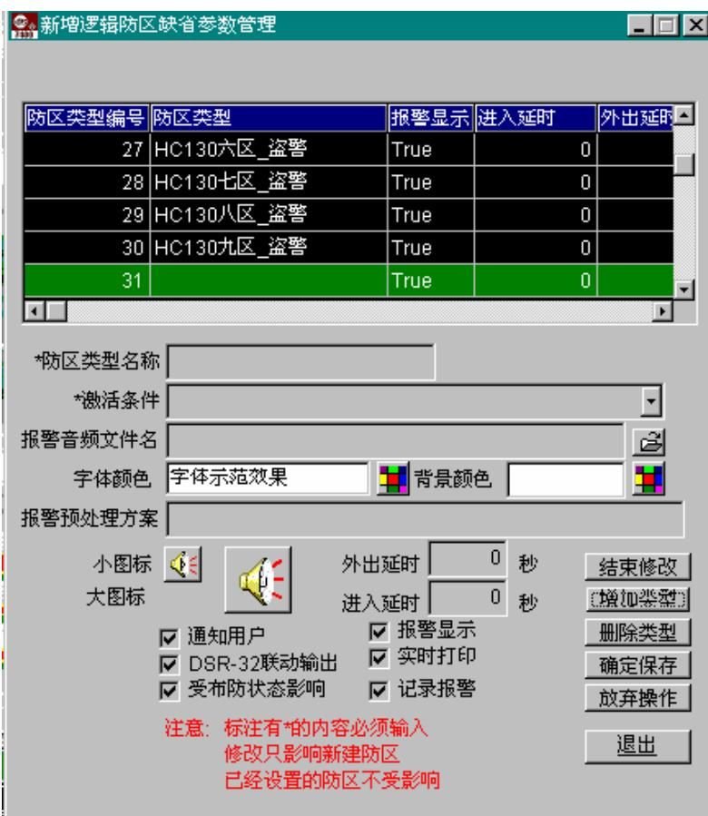
**防区类型名称:** 防区类型的名称，用来区别不同类型的防区，CMS7000 目前定义有多种类型的防区，其中巡更防区，撤布防开关，BOSCH\_VDP 巡逻，布防开关，撤防开关是特别处理的防区，他们只能进行特殊操作。巡更防区的报警事件将被作为巡更检查信号；撤布防开关的报警事件将作为对其他防区的撤布防命令处理。
