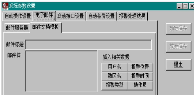
持使用汉字作为邮件标题)。邮件内容可以任意输入，需要使用到相关参数时点及右侧的相应按钮，将在邮件模板中出现由[]包括的描述字符，其中的内容不能修改，实际邮件中的内容将会被实际参数替换。
