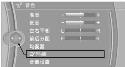
用立体声播放音频频道时会模拟多声道播放, 环绕。依据选择的音频频道自动激活或者关闭多声道播放。
