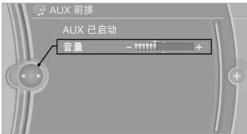
5. 旋转控制器，直至设置所需的音量，然后按压控制器。
