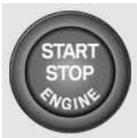
按压启动/关闭按钮即可接通或关闭点火装置以及启动发动机。
