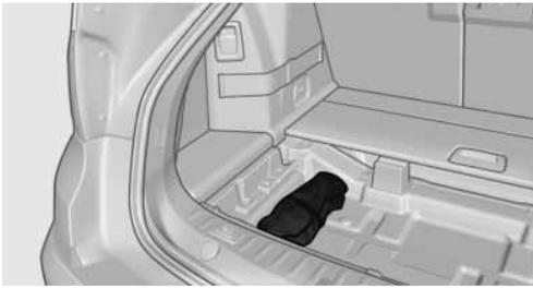
车轮螺栓防松件位于随车工具中或者随车工具旁的储物架中。
