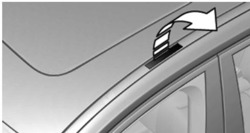
安装点位于车门上的车顶边缘。
