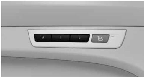
在每个遥控器中可以存储并调出两个不同的驾驶员座椅位置、外后视镜位置和方向盘位置。腰部支撑的调整没有被存储。
