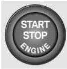
踩踏制动器并按压启动/关闭按钮。至发动机开动时松开。
