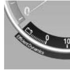
惯性滑行时，车辆动能转化为电能。汽车电池会部分充电，燃油消耗会下降。
