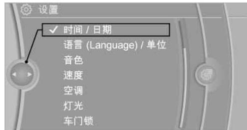
5. 旋转控制器，直至"时间:"已标记，然后按压斜控制器。
