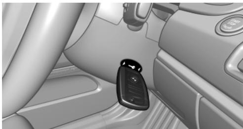
当显示相应的检查控制信息时，如图所示将遥控器保持在转向柱上的标记处并在踩下制动器时约10秒钟内按压启动/停止按钮。
