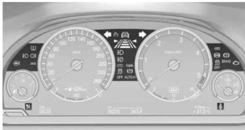
指示灯和警报灯会以不同的组合和颜色亮起。在发动机启动或点火装置接通时一些车灯会进行功能检测并短暂闪烁。
