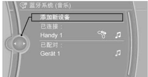
5. 执行设备的其它操作步骤，请参见设备的操作说明：例如寻找、连接蓝牙设备或者新设备。
