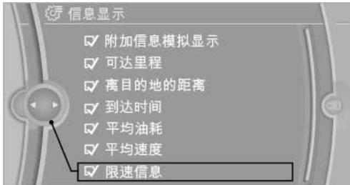
如果车速限值信息已接通，可以通过组合仪表信息显示屏的车载电脑显示。
