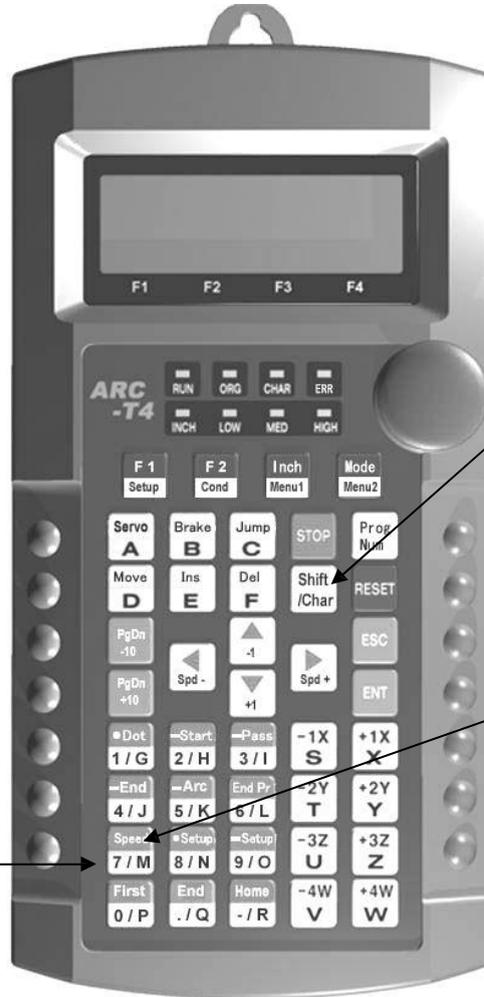
若同时按 **Shift/Char** 键和 **Speed** 键，则执行 **Speed**。在文字输入窗口，输入“M”时运行。..
