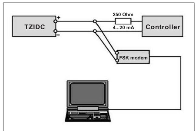
图6：通过信号线用FSK modem进行HART通信
