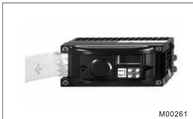
图41 打开保护盖的TZIDC-200
