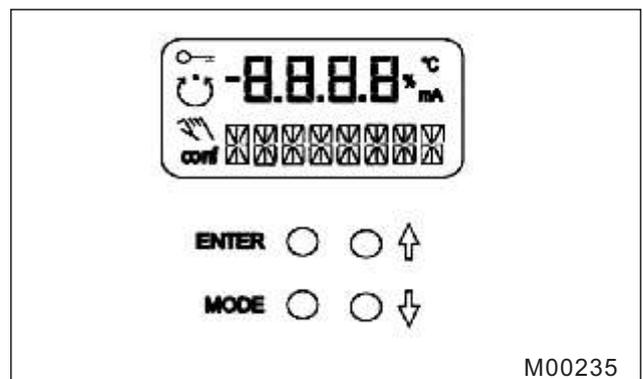
图4 TZIDC的操作按钮和显示屏
