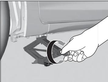
2. Gire a extremidade do suporte no sentido horário, conforme mostrado na imagem, até que o topo do macaco entre em contato com o ponto de elevação.
