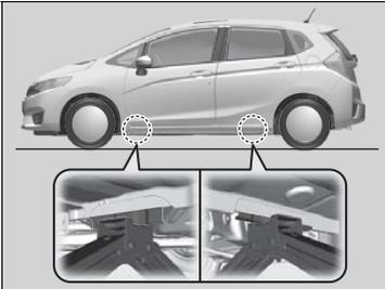
1. Coloque o macaco sob o encaixe da carroceria mais próximo ao pneu a ser trocado.
