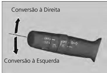
Os sinalizadores de direção poderão ser usados quando a chave de ignição estiver na posição **LIGADA**
