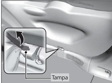
1. Coloque um pano ao redor da ponta de uma chave de fenda. Coloque-a na tampa, conforme mostrado na imagem, e abra a tampa.
