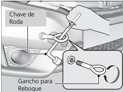
3. Retire o gancho para reboque e a chave de roda do compartimento de bagagem.
