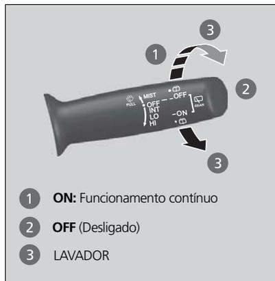
O limpador e lavador do vidro traseiro poderão ser usados quando a chave de ignição estiver na posição **LIGADA III**.
