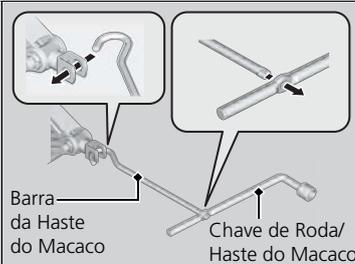
3. Levante o veículo, usando a barra da haste do macaco e a chave de roda como alavanca, até que o pneu esteja fora do chão.
