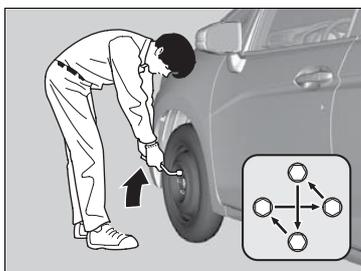
5. Abaixue o veículo e remova o macaco. Aperte as parcas da roda na ordem indicada. Continue a apertar as parcas duas a três vezes na ordem indicada.
