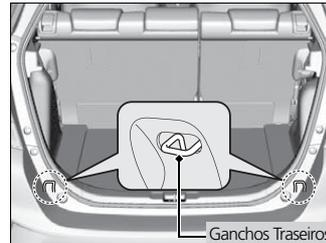
Os ganchos para bagagem no assoalho do compartimento de bagagem podem ser usados para instalar uma rede para segurar os itens.
