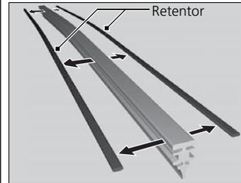
4. Remova os retentores da palheta de borracha que foi removida e instale-os na nova palheta de borracha.
