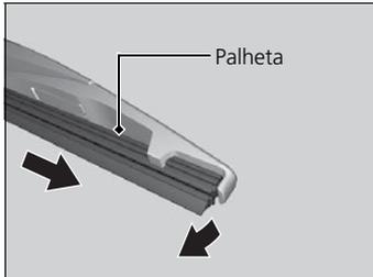
3. Deslize a palheta do limpador para fora da extremidade com o entalhe.
