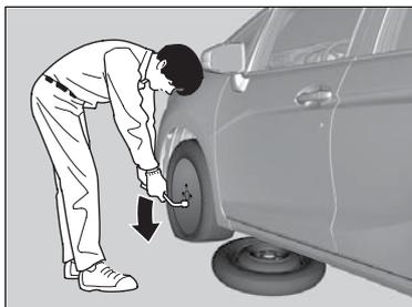
8. Solte as porcas da roda em aproximadamente uma volta, usando a chave de roda.
