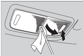
1. Pressione a borda da tampa usando uma chave de fenda para remover a tampa.
