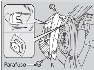
1. Use uma chave Philips para remover os parafusos.
