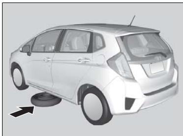
6. Coloque o estepe (lado da roda para cima) embaixo da carroceria do veículo, próximo ao pneu a ser substituído.
