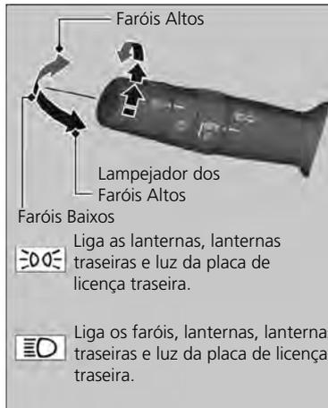
Girar o interruptor das luzes acende e apaga as luzes, independentemente da posição da chave de ignição.
