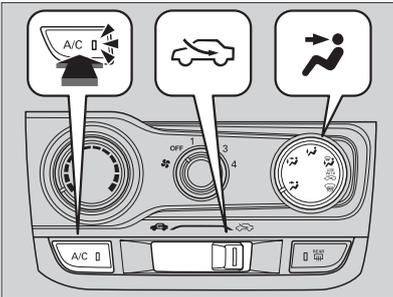
1. Ajuste a velocidade do ventilador usando o botão de controle do ventilador.
