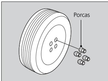
1. Remova as parcas da roda, calota e pneu furado.
