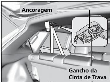
Existem dois pontos de ancoragem localizados no teto, na parte traseira do porta-malas. Para segurança adicional, utilize-os, juntamente com o cinto de segurança, se o sistema de proteção infantil estiver equipado com trava.
