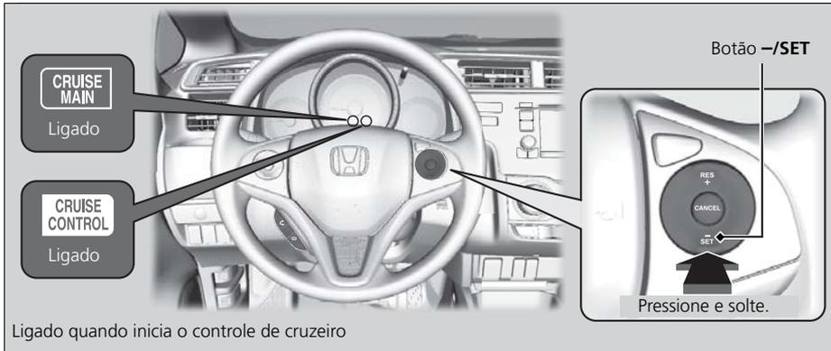
Ao atingir a velocidade desejada, pressione o interruptor **-/SET** e solte o pedal do acelerador. No momento em que soltar o interruptor **-/SET**, a velocidade será fixada e o controle de velocidade de cruzeiro será acionado. O indicador **CRUISE CONTROL** se acenderá.
