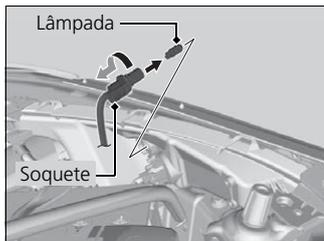
1. Gire o soquete para a esquerda e remova-o, retirando em seguida a lâmpada queimada.
