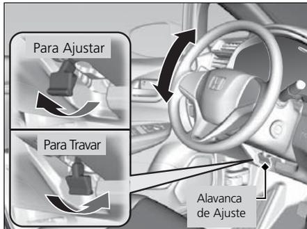
1. Puxe a alavanca de ajuste do volante de direção para cima.
